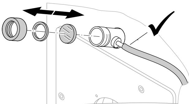
Проверить герметичность уплотнений и шлангового соединения.
