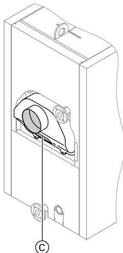
2. Удалить остаточные продукты сгорания из трубы дымохода и сборника уходящих газов (C).
