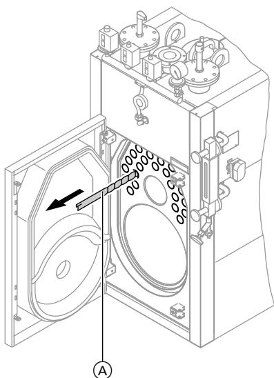
Извлечь турбулизаторы **(A)**, не применяя силы; при этом использовать приспособление для извлечения турбулизаторов, прилагаемое к устройству для чистки.
