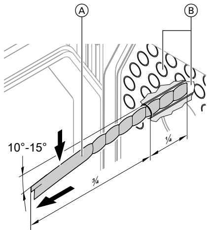
1. Вставить турбулизаторы (A) примерно на  $\frac{1}{4}$  длины в газоходы (B).
