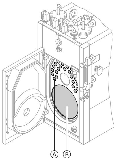
1. Очистить инструментом для чистки газоходы (A) и камеру сгорания (B), а также удалить остаточные продукты сгорания.
