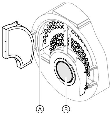
1. С помощью подходящего устройства для чистки очистить газоходы (A), камеру сгорания (B) и заднюю поворотную камеру и удалить остаточные продукты сгорания.
