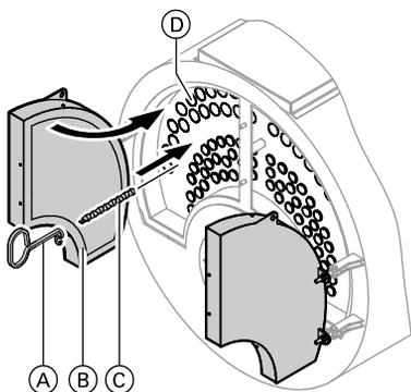
1. Вставить турбулизаторы (C) (только в 3-м газоходе (D)) до упора; для этого использовать приспособление для извлечения турбулизаторов (A).
