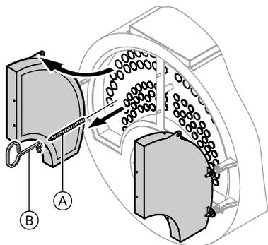
Извлечь турбулизаторы (A), не применяя силы; для этого использовать имеющееся в комплекте поставки приспособление для извлечения турбулизаторов (B).
